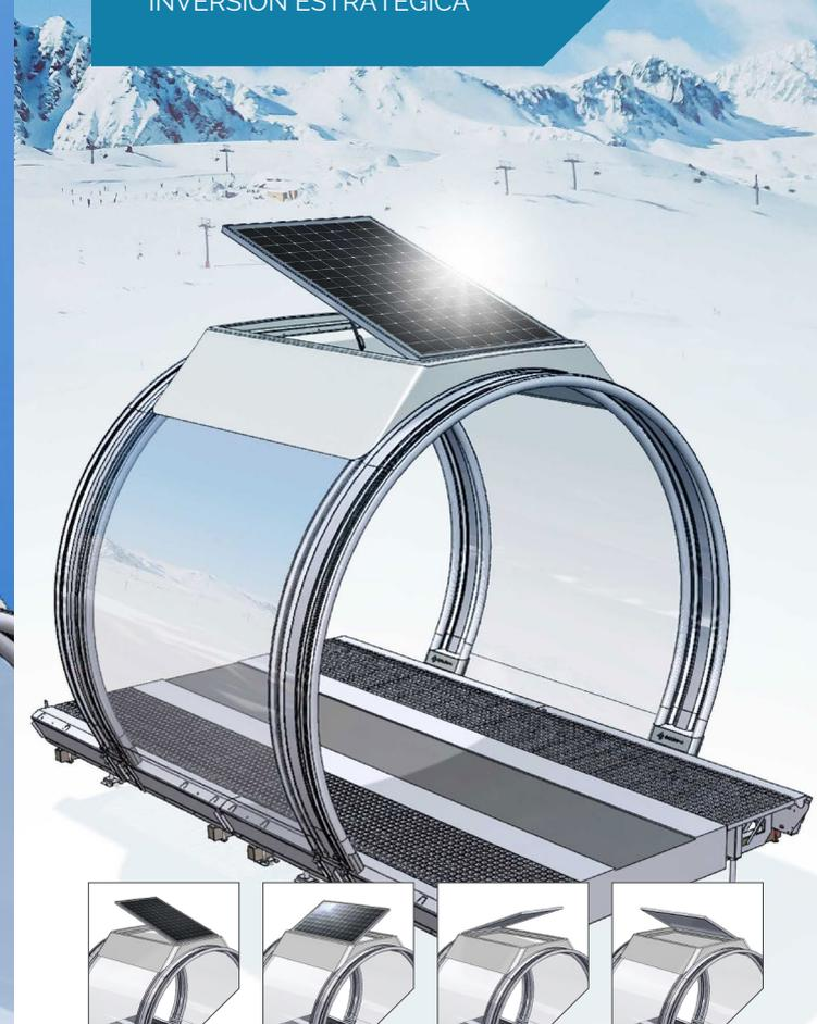
LOS PANELES SE PUEDEN INCLINAR EN LAS 4 DIRECCIONES
